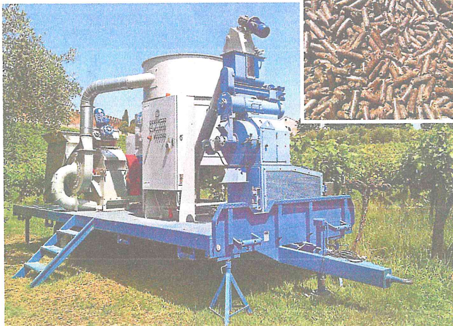
Foto 7 Esempio di pellettificio mobile e (nel riquadro) pellet di legno di vite (Nazareno Costruzioni)
