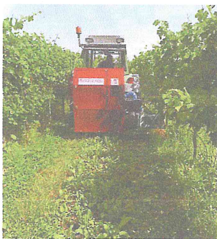
Foto 1 La macchina per il pirodiserbo a pellet di legno in lavoro in vigneto a giugno 2018
